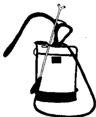
(গ) দুই নজলবিশিষ্ট ব্যাগসাক সিকন যন্ত্র (Knapsack Sprayer - Double Nozzle)
